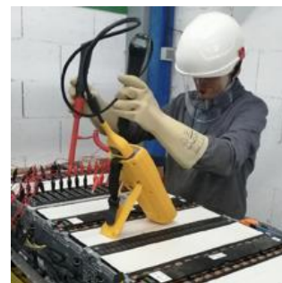
Operario de Little Electric Cars realizando un test a una batería
