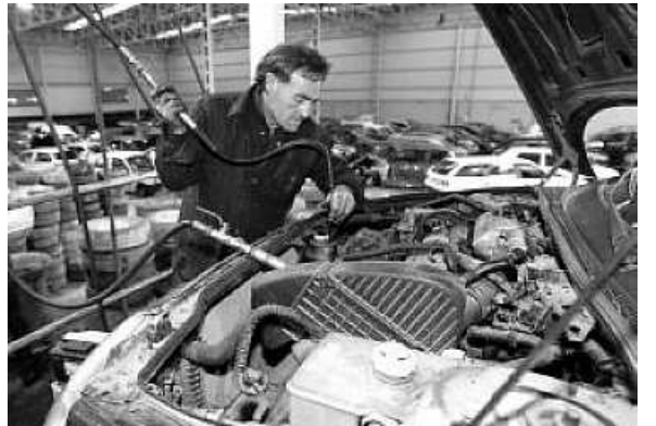
1. DESCONTAMINACIÓN. Todo vehículo que llega a un desguace debe ser descontaminado. Para ello, se extraen los líquidos de frenos y refrigeración, los anticongelantes, aceites, baterías y valvulinas. Todo ello se almacena en contenedores especiales para su tratamiento por empresas certificadas. Lo mismo ocurre con los neumáticos. Sólo los nuevos son vendidos. GOÑI
