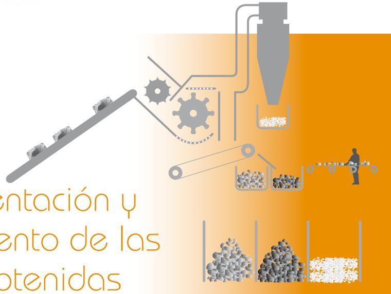
El siguiente paso será la alimentación del material a la **ZONA DE FRAGMENTACIÓN**. Normalmente, la alimentación se realiza mediante un dispositivo de carga constituido, en la mayoría de los casos, por una grúa fija con un brazo articulado de largo alcance que dispone de un pulpo hidráulico en su extremo.
