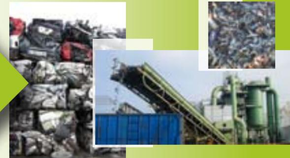
El resto de materiales son sometidos a distintos procesos de segregación (cribados, corrientes de inducción, mesas densimétricas, sistemas ópticos, etc.) para obtener por un lado los distintos metales no férricos (aluminio, cobre, etc.) que son enviados a plantas de fundición y por otro otras fracciones de materiales no metálicos que se reciclan o se valorizan energéticamente dependiendo de sus características.
