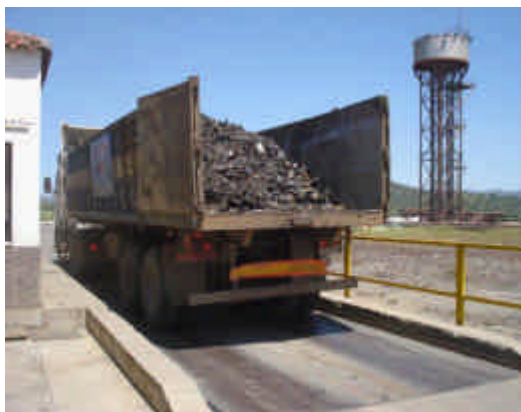
Pesaje de fracciones y recogida de datos de básculas Fuente: Elaboración propia
