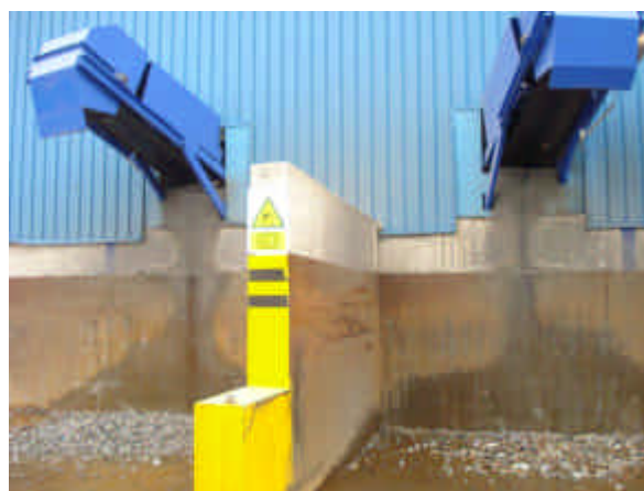
Cintas limpias y tratamiento de la fracción "gomas con metales" en las plantas de medios densos. Fuente: Elaboración propia
