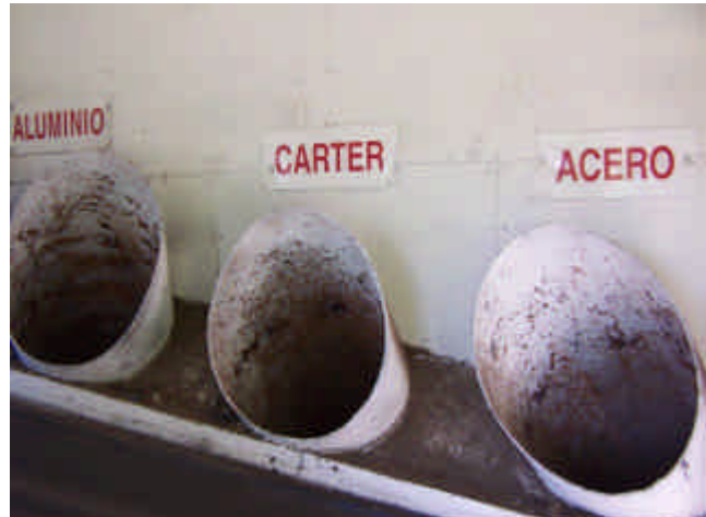
Sistemas manuales de separación de materiales tras la fragmentación
