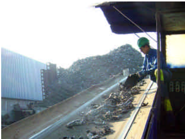
Sistemas manuales de separación de materiales tras la fragmentación
