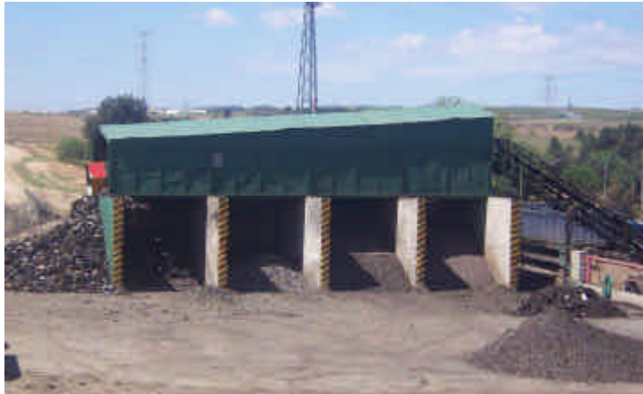
Separación de distintos materiales tras la fragmentación
