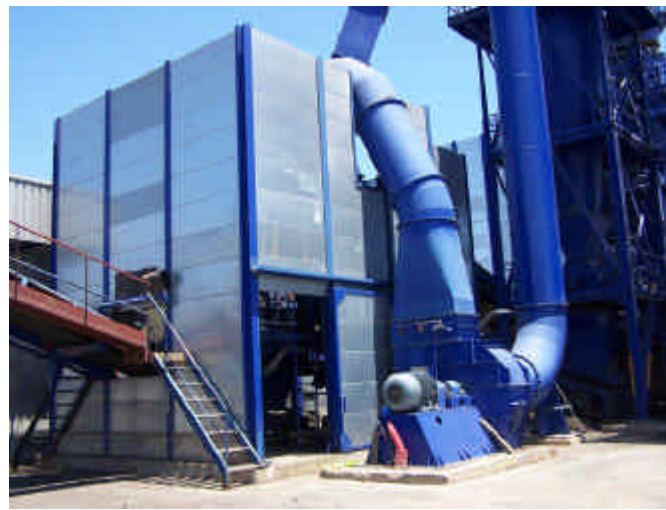
Distintos ejemplos de protección acústica de las instalaciones
