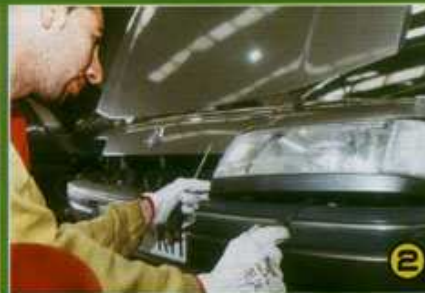
Carrocería: en la primera etapa de la descontaminación, se separan los faros, las ruedas, la batería y las piezas exteriores que funcionen y puedan venderse
